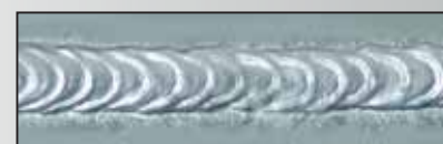
MIG PULSE ON PULSE welding on aluminium • Saldatura MIG PULSE ON PULSE su alluminio • Soldage MIG PULSE ON PULSE sur aluminium • Soldadura MIG PULSE ON PULSE en aluminio • Schweißen MIG PULSE ON PULSE auf Aluminium • Сварка MIG PULSE ON PULSE на алюминии
