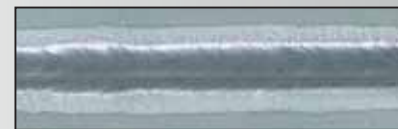
MIG PULSE welding on aluminium • Saldatura MIG PULSE su alluminio • Soldage MIG PULSE sur aluminium • Soldadura MIG PULSE en aluminio • Schweißen MIG PULSE auf Aluminium • Импульсная сварка MIG PULSE алюминия
